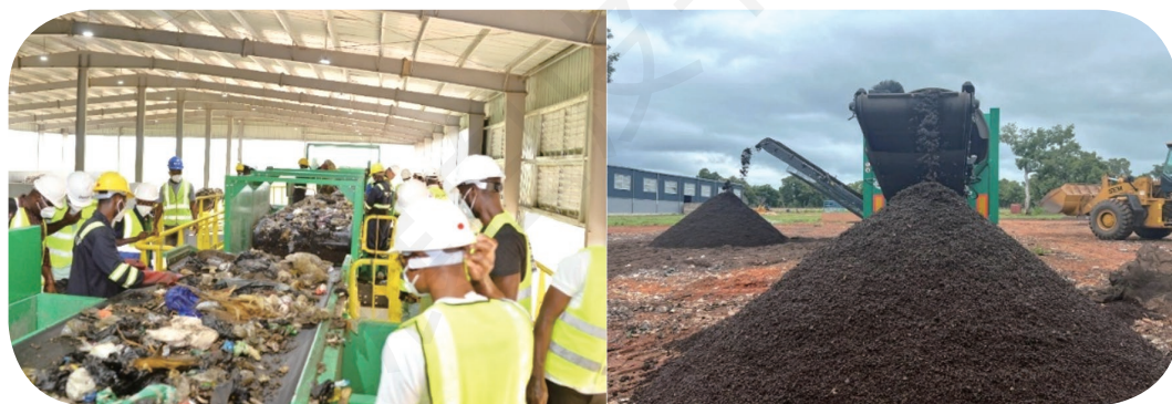
图4.7 在传送带上人工挑选城市固体废物及堆肥物料正在进行筛选
